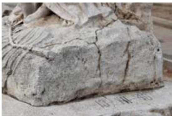
Imagen 191. Fractura transversal y fisuras vinculadas. Alveolización y costra marrón en la base.
