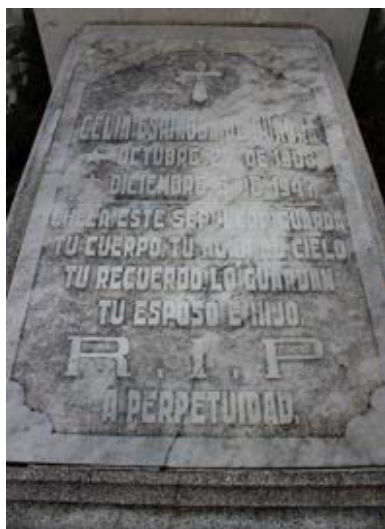
Imagen 122. Fisura individual e invasión de pitting en la lápida.
