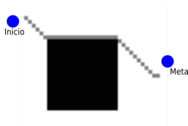
Figura 2.8: Ejemplo de ejecución de una trayectoria evitando chocar con un obstáculo.
