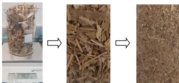
Figura 2. Proceso de preparación física de la paja de maíz
