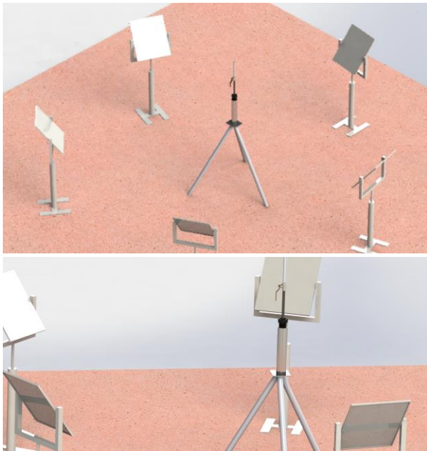
Figura 4. Disposición del sistema de generación de vapor
