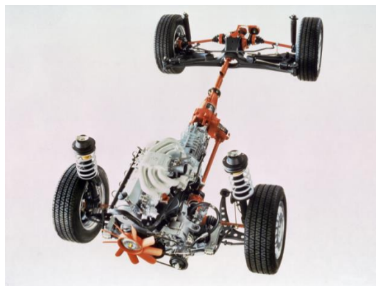
Imagen 17. Componente propshaft, Fuente: Archivos de GKN (2015)
