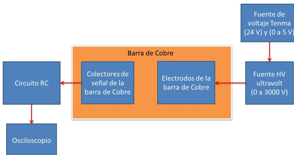
**Figura 5.1:** Diagrama del sistema de detección sin la etapa de adquisición de datos.
