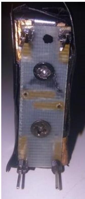
**Figura 4.6:** Tarjeta electrónica conectada a la barra, vista frontal con los 4 pines.
