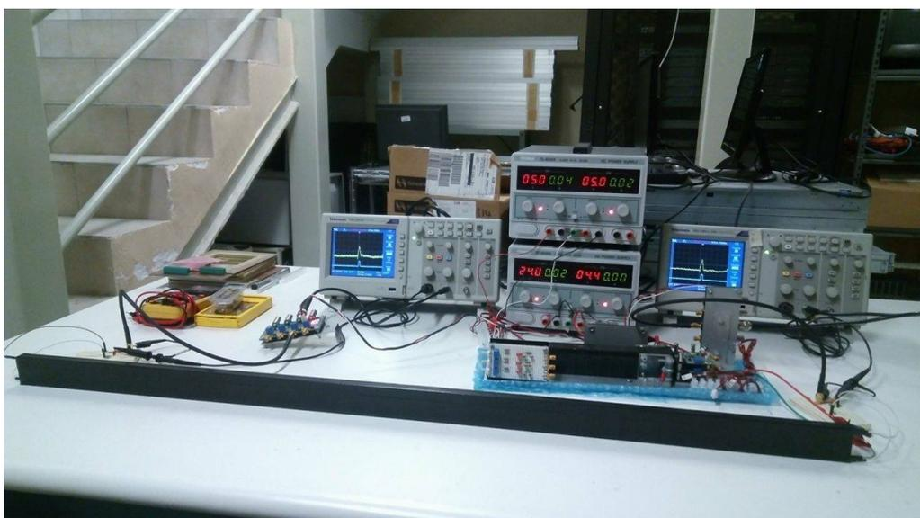
**Figura 5.6:** Sistema de detección con los dos canales de ionización activados. En los osciloscopios la señal azul es la digital y la amarilla la analógica.
