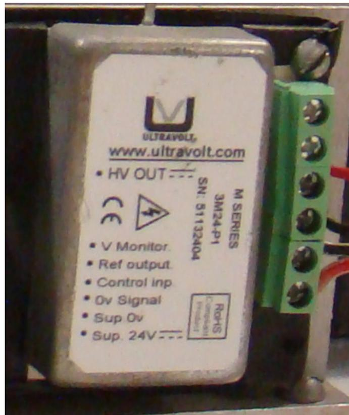
Figura 4.8: Fuente Ultravolt de alto voltaje.
