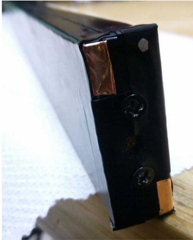
**Figura 4.5:** Electrodo de alimentación en la barra, en la configuración final.
