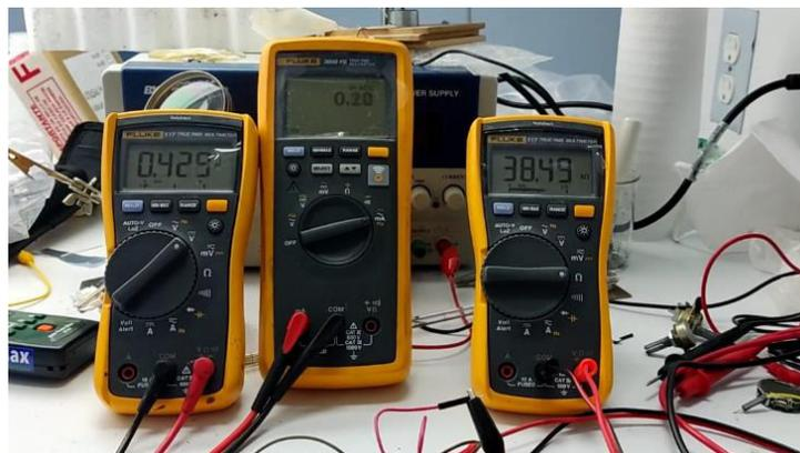
**Figura 28** Instrumentación para medir la potencia en luz difusa.
