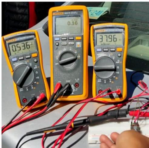
**Figura 30** Medición de la celda de OG con luz solar Directa.
