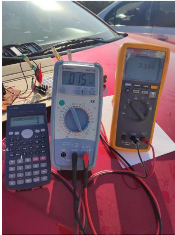
**Figura 39** Circuito con Celda fotovoltaica de OG, circuito regulador de voltaje, calculadora y 2 multímetros para medición de corriente y voltaje.
