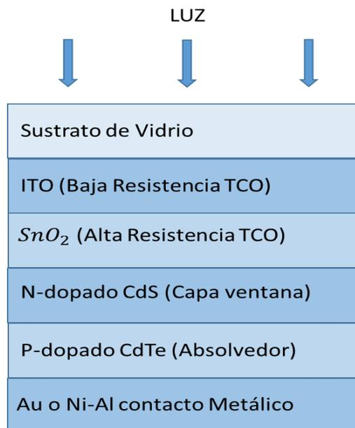
**Figura 4** Esquema de distribución de capas en una celda solar de película delgada.
