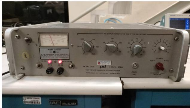
**Figura 3.22:** Fuente utilizada para aplicar alto voltaje en el dispositivo experimental. *Figura hecha por José Francisco Ambriz Gutiérrez.*
