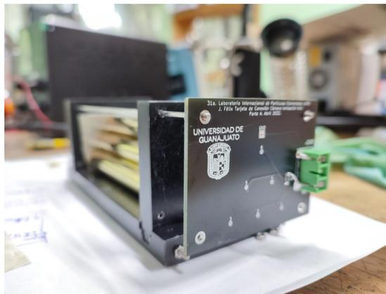
**Figura 3.17:** Se muestra el dispositivo con una de las tarjetas electrónicas siendo montada, para así proceder al tensado de fibras. *Figura hecha por José Francisco Ambriz Gutiérrez.*
