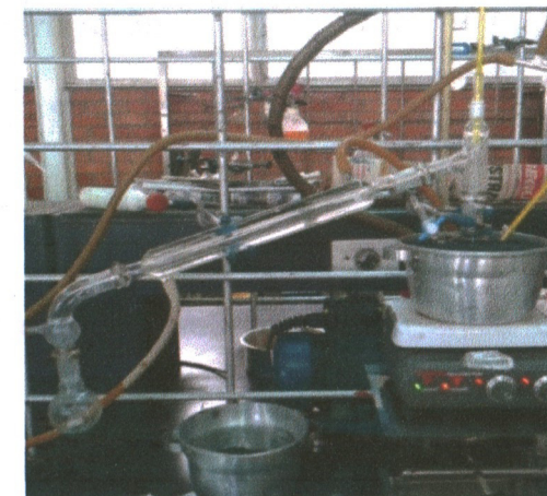
Figura 4.1. Sistema de reacción para la obtención de los alcóxidos de silicio derivados del dietilenglicol (precursores de la UGM-triamin)
