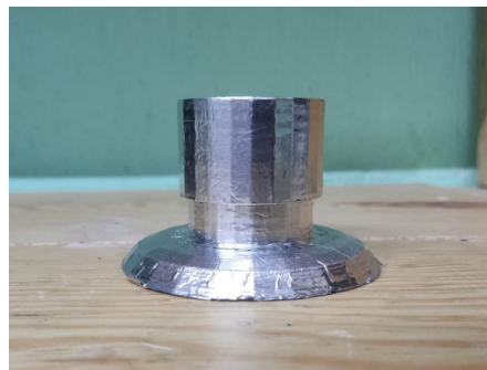
(d) Capped support.
