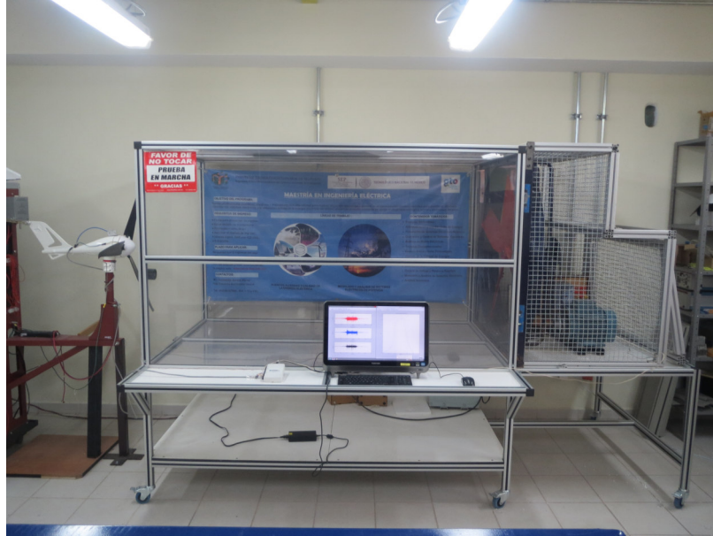
Figura 3.1: Configuración del banco de pruebas mostrando el aerogenerador dentro del túnel de viento y el sistema de instrumentación.
