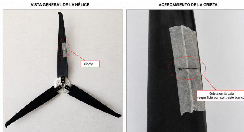
Figura 3.2: Detalle de la pala instrumentada ilustrando el nivel de severidad de la grieta.
